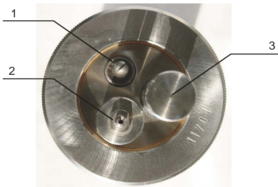
Rys. 4. Bomba kalorymetryczna w rzucie poziomym. 1 – kołek kontaktowy elektrody, 2 – zawór wylotowy z kołkiem kontaktowym elektrody, 3 – zawór wlotowy.
