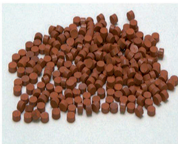
Rys. 6. Katalizator f-my YARA (po lewej) w formie pierścieni siedmiootworowych \varnothing_{zewn.} = 9 mm, po prawej katalizator polski PKR-1 (w formie tabletek 5x5 mm).
